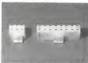
JST製VHコネクタ。左は3ピンのもの。右は8ピン。白い樹脂製だ。
